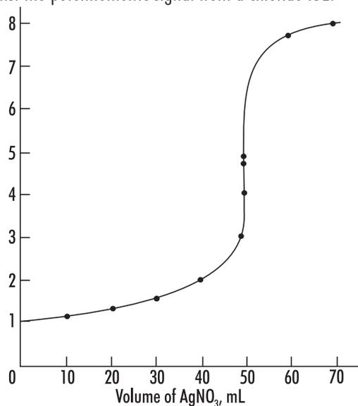
**Figure 5:** Argentometric titration
