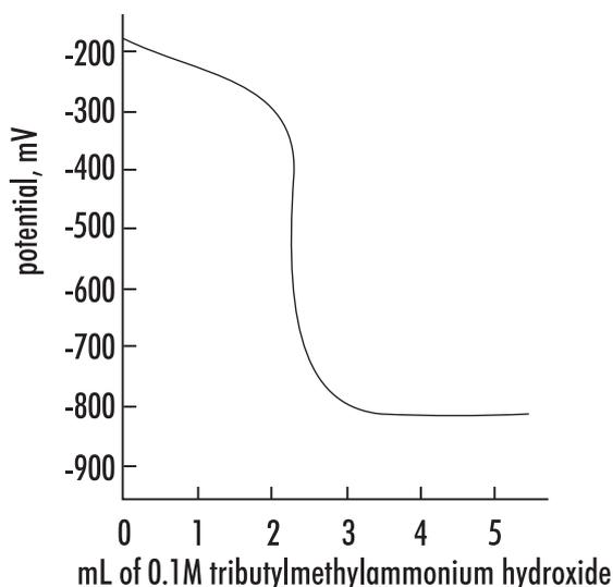
**Figure 7:** Non-aqueous titration
