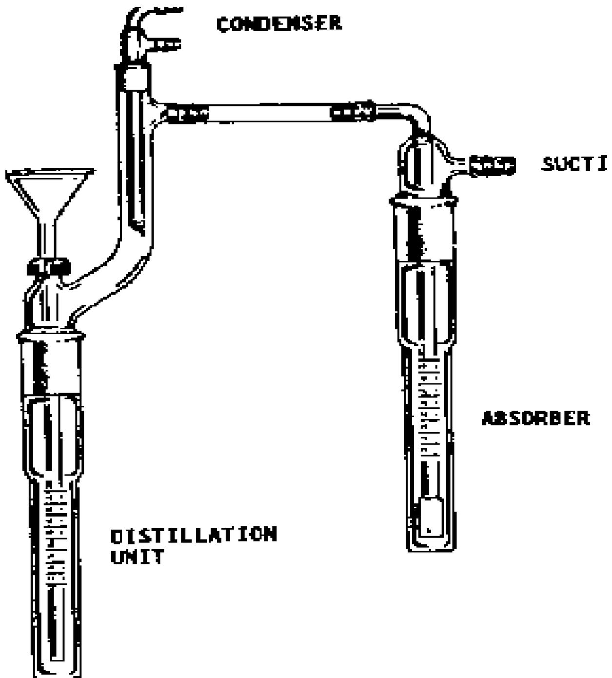
**FIGURE 1. MIDI DISTILLATION APPARATUS**
