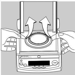
Waagschale bei Analysenwaagen abnehmen und reinigen:
